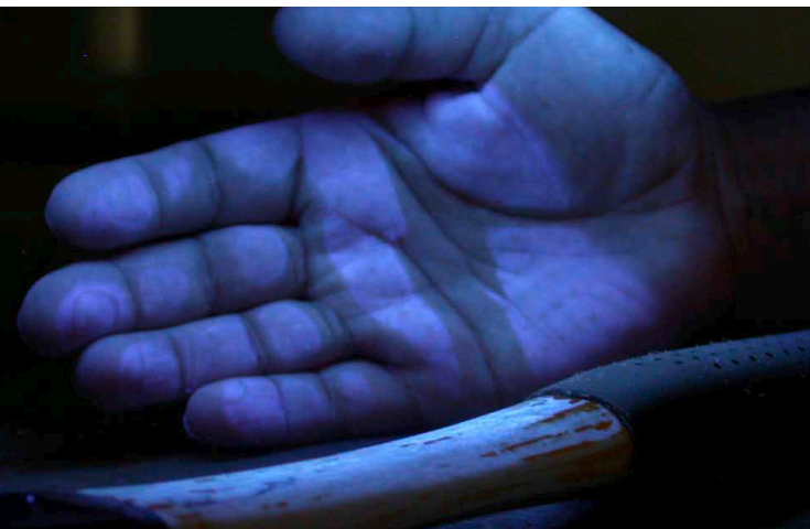
Hand (mit Feuchtigkeitscreme leicht eingecremt) nach einmaligem Anfassen eines gummiummantelten Hammerstiels. Unter UV-Licht fluoreszieren die Stellen, auf die durch den Kontakt mit dem Gummi PAK übertragen wurden. Löcher in der Ummantelung zeichnen sich ab.
